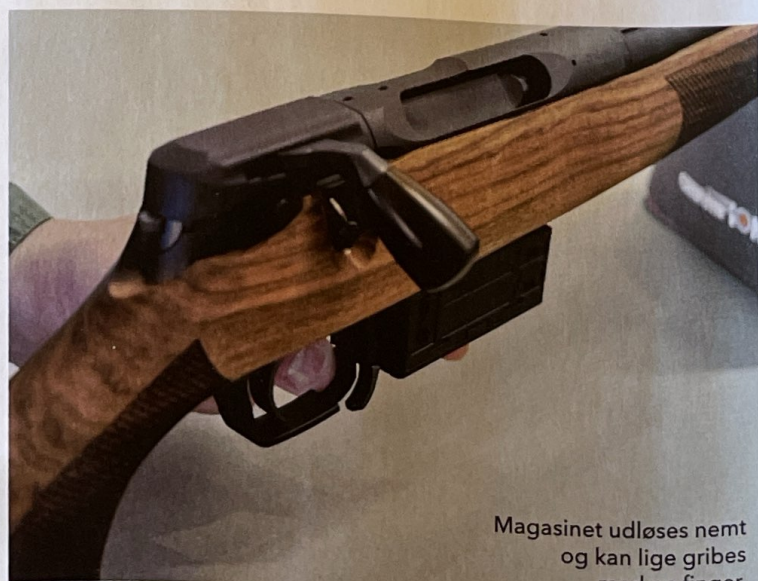
Sikringen sidder over skæftet, mens udløseren til bundstykket er flyttet ned, hvor grebet plejer at ende.
