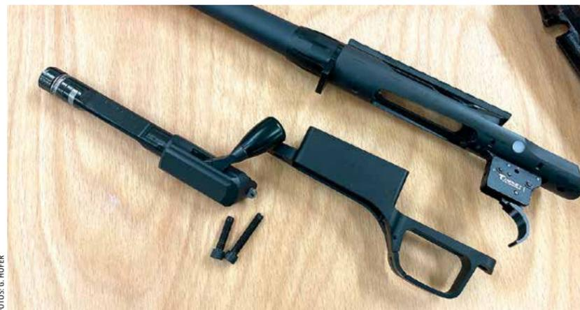
Der Strasser RS 700 basiert auf einem Remington-Repetierer mit Zylinderverschluss. Durch das Austauschen der Verschlusshülse wird daraus ein Geradezugrepetierer. Der RS 700 verfügt zusätzlich über einen Präzisionslauf von Lothar Walter, einen Abzug von Timney sowie einen Magazinschacht.
