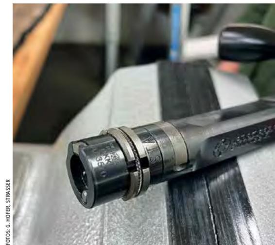
Der Geradezugverschluss verriegelt über vier Radialelemente in der Hülse.
