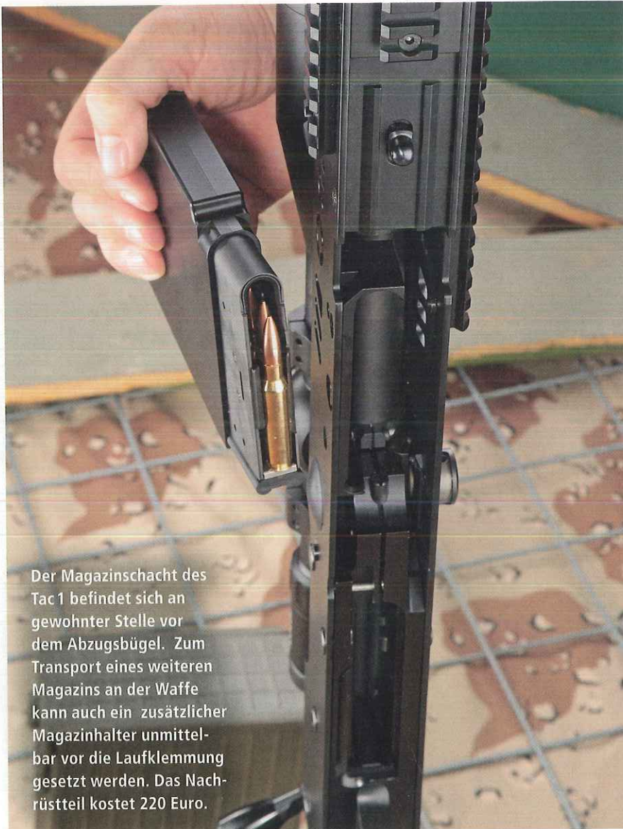
Im Magazin des Tac1 werden die Patronen unter der obersten durch eine Schiene, die in die Ausziehherrille greift, hinten gehalten.
