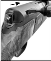
4.8 Führen Sie nun den Verschluss in den Verschlusskasten ein. Dafür muss der Kammergriff in rückwertiger Position sein bzw. müssen die Verschlusselemente im Verschlusskopf im eingefahrenen Zustand sein (nicht expandiert). Das Einführen des Verschlusses ist sonst nicht möglich. Achten Sie dabei auf eine exakte Positionierung des Verschlusses d.h. waagrecht zum Verschlusskasten um den Verschluss in seine Führungen einsetzen zu können.
