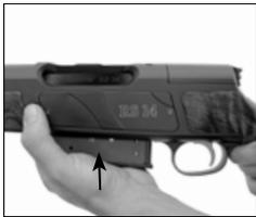
4.9 Magazin in den Magazinschacht einsetzen und einrasten lassen.
