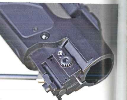
Om du skjuter din Strasser glapp vid pipinfästningen är inte det något problem alls. Skulle det uppstå finns en justerskruv som tighar upp låsningen igen.
